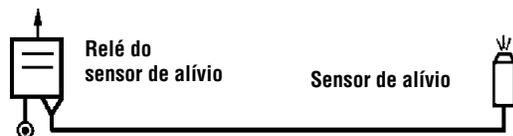
No estado de repouso, o sensor de alívio está aberto, e o ar de suprimento está em exaustão. No funcionamento o sensor está bloqueado, a pressão se eleva imediatamente no tubo de conexão do relé do sensor e o mesmo abre, emitindo um sinal de saída.
