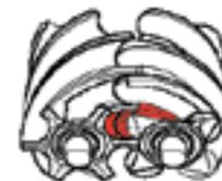
d - O ar comprimido é suavemente descarregado do compressor, ficando a abertura de descarga selada, até a passagem do volume comprimido no ciclo seguinte.
